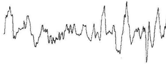
Rys. 7. Chropowatości powierzchni łopatki wykonanej metodą stereolitografii, ( L_t=3,2 mm, R_a=1,434 \mu\text{m} , R_z=9,93 \mu\text{m} ) Fig. 7. Surface roughness of stereolitografy model of turbine engine blade, ( L_t=3,2 mm, R_a=1,434 \mu\text{m} , R_z=9,93 \mu\text{m} )
